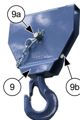
Rys. 46: Montaż zblocza hakowego 2
